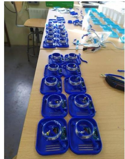
Es en este momento cuando **nacieron** los primeros **“Gallico2”**, cuyo montaje supuso una labor tediosa debido a la complejidad del cableado interior. Para solucionar este problema y agilizar la fabricación, se procedió a diseñar una primera placa de circuito impreso PCB, que redujo el cableado drásticamente y facilitó el montaje.
