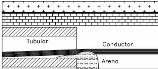
Si las pendientes son muy pronunciadas y el terreno es rocoso e impermeable se corre el riesgo de que la zanja de canalización sirva de drenaje, originando un arrastre de la arena que sirve de lecho a los cables, en este caso el tramo afectado se deberá entubar y asegurar la canalización con hormigón.
