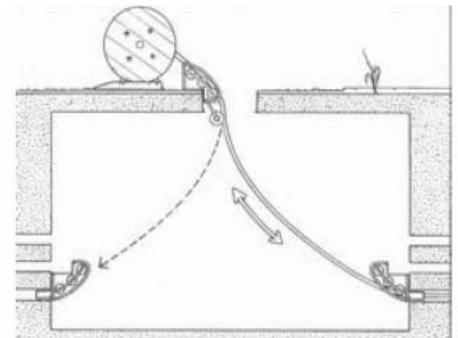
El tendido se hará desenrollando el cable obligatoriamente sobre rodillos situados en el interior de la zanja, que puedan girar libremente y contruidos de forma que no dañen al cable. Solo de manera excepcional se autorizara desenrollar el cable fuera de la zanja.
