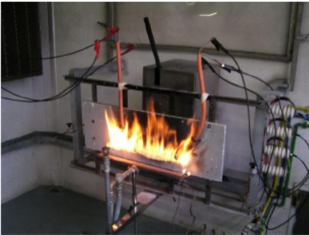
Estos cables RESISTENTES AL FUEGO, denominados (AS+), cumplen con lo establecido en la ITC-BT-28 "Locales de pública concurrencia", para las instalaciones de circuitos de seguridad no autónomos, o en circuitos de servicio con fuentes autónomas centralizadas.
